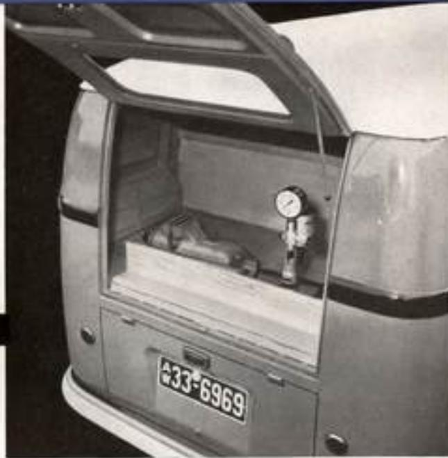
Mit wenigen Handgriffen wird der Schraubstock ausgeschwenkt, die Arbeit kann beginnen.
