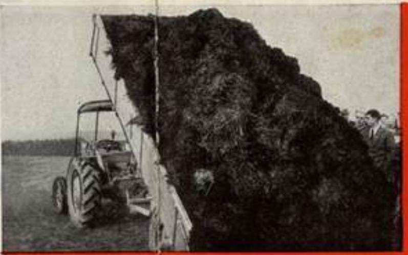
▲ **FERGUSON-STALLMISTSTREUER** machen in Verbindung mit dem Frontlader das Stallmistausbreiten zu einer reinen Einmannarbeit. Der Stallmiststreuer faßt 1,5 t und vermag strohigen genau so gut wie verrotteten Stallmist zu verteilen. Bodenantrieb. ►
