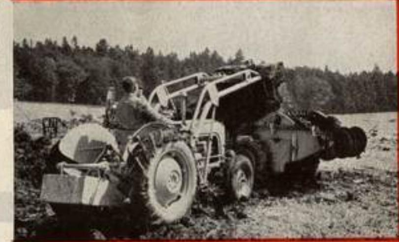
**FERGUSON - HOCHLADER** bieten für ungezählte Arbeiten eine wesentliche Erleichterung und ein Traktorfahrer leistet mit diesem Gerät so viel wie 10 Arbeitskräfte. Statt der Stallmistgabel kann eine Schotterschaufel aufgesetzt werden. Hubkraft 900 kg. Ladehöhe 3,40 m. ►
