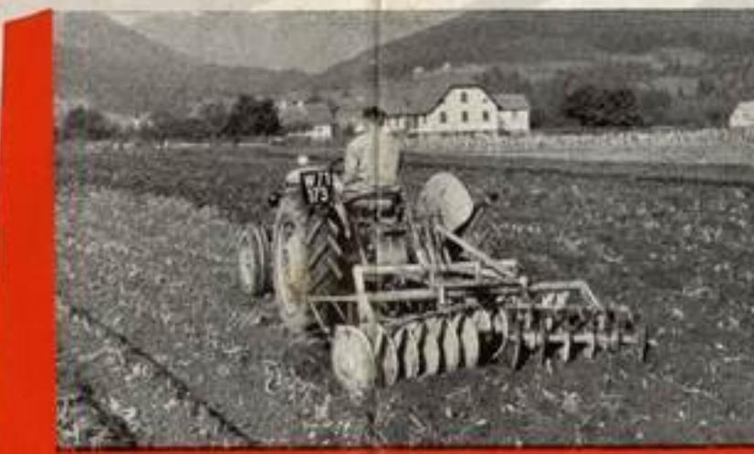
▲ **FERGUSON - SCHEIBENEGGEN**, getragen, verstellbar und seitlich versetzbare, sind hervorragende Geräte zur Bearbeitung grobscholliger und schwerer Böden. Ebenso geeignet zum Stoppelsturz und Einbringen von Vegetationsrückständen.
