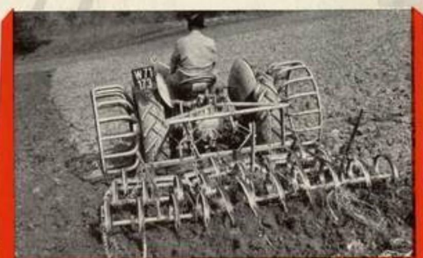
Das **FERGUSONSYSTEM** führt Traktor und Gerät zu einer Arbeitseinheit zusammen und trotzdem ist der Traktor nicht an ein Gerät gebunden. Man kann in kürzester Zeit und mühelos auf verschiedene vorne, in der Mitte oder hinten montierte Geräte umstellen.
