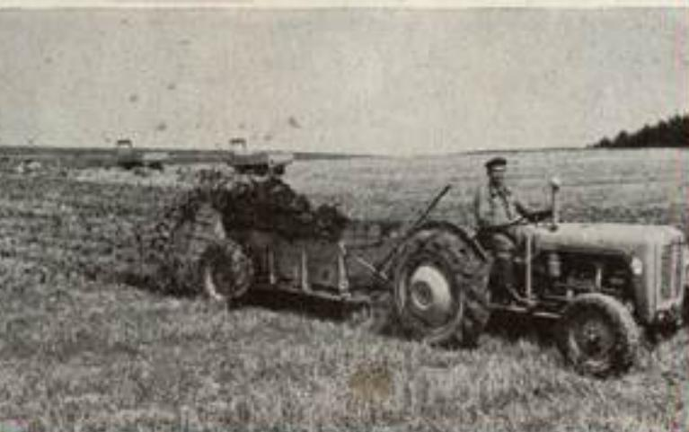
◀ **FERGUSON - EINACHSSKIPPER** haben je nach Bordwandlänge (3,40 m oder 4 m) eine Ladekapazität von 3 bzw. 4 Tonnen. Durch die Gewichtsverlagerung auf die Hinterachse des Traktors wird dessen Zugkraft wesentlich erhöht, so daß sie bei schlechten Bodenverhältnissen voll geladen werden können. Weitere Transportgeräte sind: Ladepritsche für 150 kg, Transportkasten, fassend 350 kg, Hecktransportgabel.
