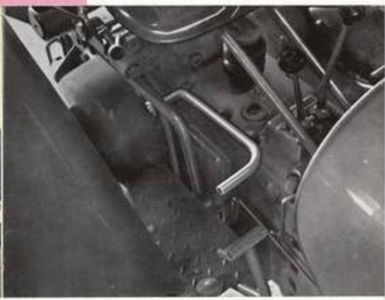
Die serienmäßig eingebaute Differentialsperre kann sowohl mit der Hand betätigt werden, indem der Fahrer den Hebel nach oben zieht, als auch mit dem Fuß, wobei der Hebel nach unten getreten wird. So kann der Fahrer jederzeit die am günstigsten erscheinende Bedienungsart der Differentialsperre wählen.
