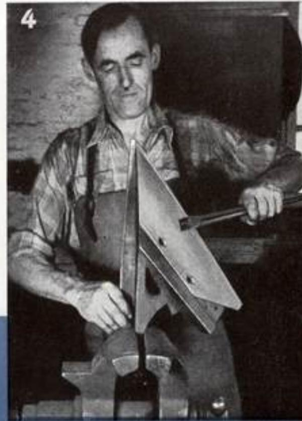
Schneide auf eine Richtplatte gelegt wird, so soll die Linie Scharspitze - Scharschneidende in der Mitte der Schneide um ca. 2 mm von der Auflage abstehen.
